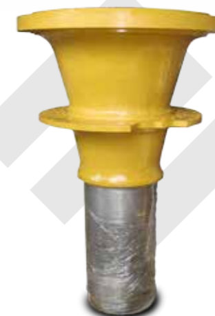
Spindle completamente reparado
